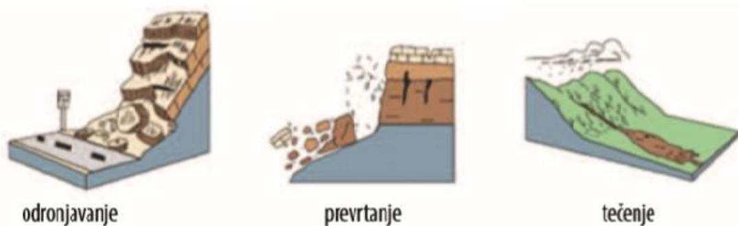
Slika 24: Prikaz osnovnih tipova klizanja prema mehanizmu kretanja
